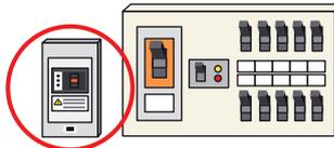
分電盤に内蔵又は後付したセンサーが揺れを感知し、ブレーカーを切って電気を遮断します。
